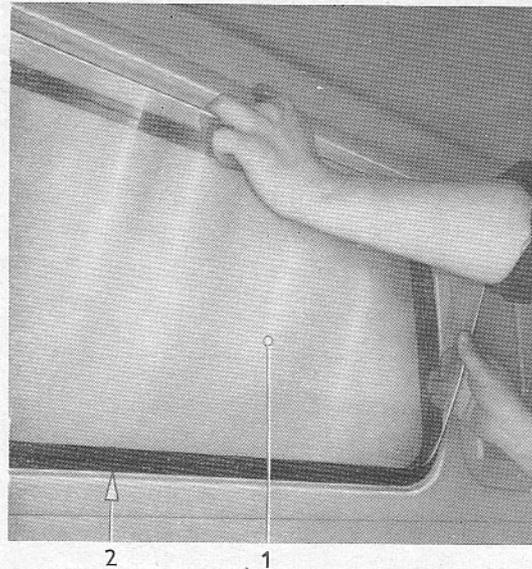
Bild 24 – Rückwandscheibe einsetzen
