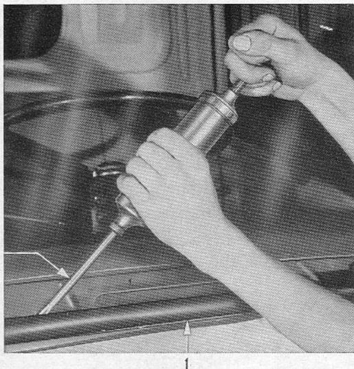
Bild 14 – Zwischen Gummifassung und Windschutzscheibe von Außenseite ringsum Fensterdichtungsmasse L 000 779/0 ausgießen
