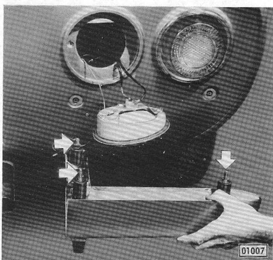
Durch Öffnung für Brems- und Schlußleuchte sind die Befestigungsschrauben am Stoßfängerteil zugänglich.
