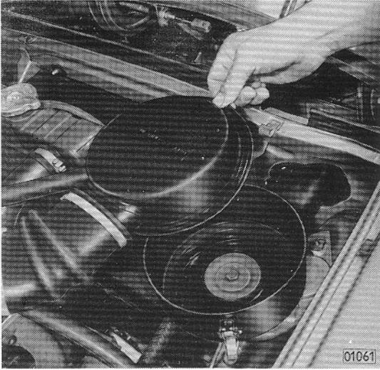
Zum Aus- und Einbau der Stoßdämpfer muß auf der rechten Seite sowohl in Verbindung mit dem 1,1 Ltr.-SR- als auch mit dem 1,9 Ltr.-S-Motor das Luftfilter ausgebaut werden.
