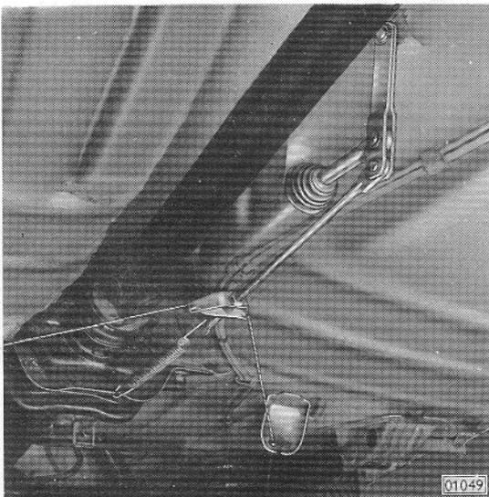
Die Anordnung der Handbremse des GT entspricht bis auf den zusätzlichen Umlenkmechanismus am Wagenboden der der Kadett-Modelle. Der Umlenkhebel ist mittels einer Brücke am Gelenkwellentunnel befestigt.
