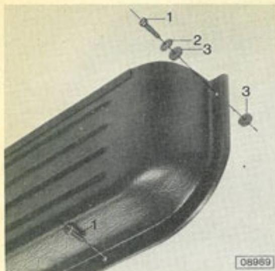
Türablageschale mit 4 Blechschrauben anschrauben. Hierbei, wie nebenstehend gezeigt, an den beiden oberen Befestigungsstellen jeweils 2 Gummischeiben und eine Unterlegscheibe mitverwenden. Diese Teile sind für die Aufnahme von Schwingungen vorgesehen.
