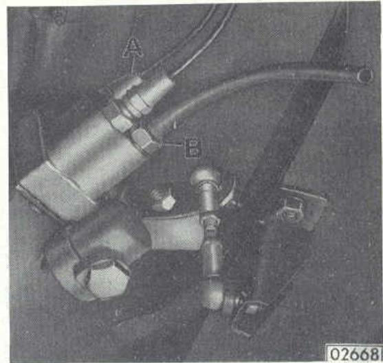
Ein Verzögerungsmechanismus im Innern des Niveauregelventils verhindert das Ansprechen des Ventils auf die beim Fahrbetrieb durch Fahrbahnunebenheiten entstehenden Bewegungen. So wird vermieden, daß der Kompressor unnötig arbeitet, um die bei jeder Hinterachsbewegung entweichende Luft zu ersetzen.
