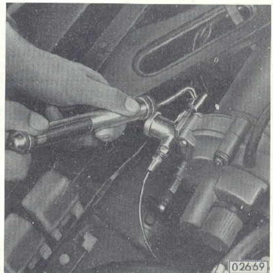
Anschließend beide Sicherungsbügel am Einstellgestänge des Höhenstandsventils demontieren. Einstellgestänge von den Kugelköpfen am Steuerhebel des Ventils und am oberen Lenker abnehmen. Das Gestänge ist nach dem Lösen der Kontermuttern zunächst auf das Maß  $X = 75 \text{ mm}$  einzustellen.
