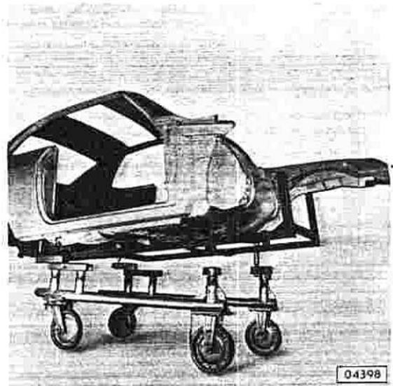
Anlageflächen am neuen Längsträger blanksäubern und einpassen. Vorder- rahmen-Prüf- und -Schweißvorrichtung KM-114 mit Längsträger einsetzen. Längsträger punktschweißen. Wo im Bereich der Stirnwand kein Punktschweißflansch vorhanden ist, ist elektrisch zu schweißen.
