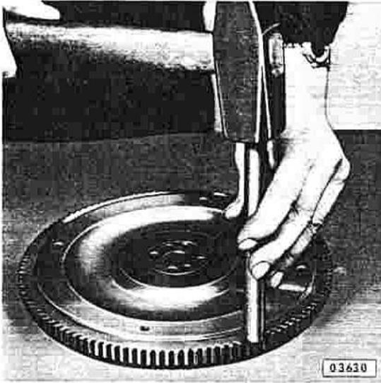
Neuen Anlaßzahnkranz gleichmäßig auf 180 - 230°C erwärmen (strohgelbe Anlauf-farbe) und - Innenfase zum Schwungrad - mit Messingdorn gleichmäßig bis zur satten Anlage auftreiben.
