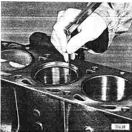
Kolbenringstoß in Zylinder eingelegtem Kolbenring mit Fühllehre messen.
