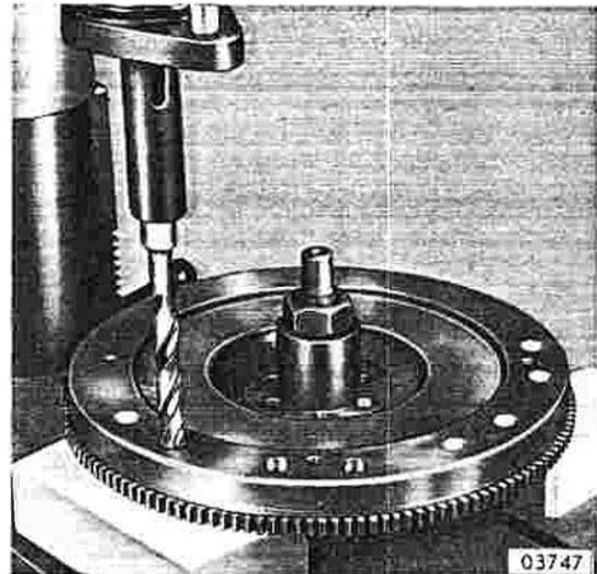
Die Auswuchtlöcher sind auf einem Radius von  $130 \pm 1$  mm mit einem 14-mm-Bohrer zu bohren. Die max. Bohrtiefe darf 16 mm nicht übersteigen. Im 20-mm-Bereich der vorhandenen Kupplungsbefestigungslöcher darf nicht gebohrt werden. Sind mehrere Bohrlöcher erforderlich, ist ein Abstand von  $40 \pm 1$  mm einzuhalten.
