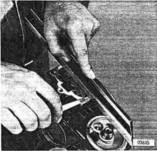
Höhenspiel der Zahnräder prüfen. Dazu Ölpumpenräder ohne Öl einzeln in Pumpenraum einsetzen und mit Haarlineal und Fühllehre Höhengspiel messen. Zulässiges Höhengspiel ist vorhanden, wenn die Stirnflächen der Zahnräder 0 bis 0,10 mm über der Deckelanlagefläche hervorstehen. Ein durch die Zahnräder stirnseitig eingelaufener Pumpendeckel ist zu erneuern.
