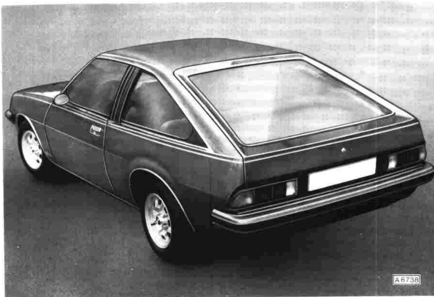
In den Fahrwerksteilen entspricht der Manta-CC dem Manta-B, wobei jedoch Einzelteile auf die geänderten Verhältnisse abgestimmt wurden. Die Karosserieteile gleichen bis auf die geänderte Heck- und Dachpartie denen des Manta-B. Durch Umklappen der Rückenlehne kann der Gepäckraum wesentlich vergrößert werden.
