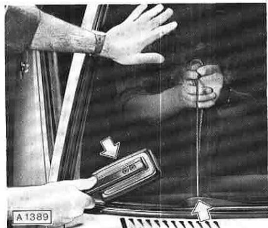
Zwischen äußerer Abdichtlippe der Gummifassung und Windschutzscheibe Flachdüse der Hand- oder Druckpresse einführen. Hohlräume ringsum mit Fensterdichtungsmasse – bei Verbundglasscheiben mit Windschutzscheibenkleber – auslegen.
