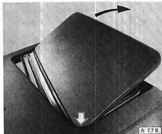
Vor dem Einlegen des Deckels in die Dachöffnung ist darauf zu achten, daß beide Stützhebel „D“ (linke und rechte Seite) mit der Spitze unten nach außen zeigen.
