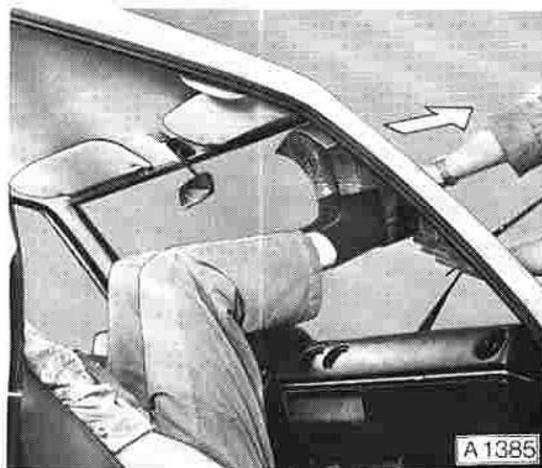
Neue Windschutzscheibe auf Glasscheiben-Haltevorrichtung der Fa. Hazet, Nr. 1618 oder vorhandene Haltevorrichtung SW-373 aufsetzen. Neue Gummifassung auf Scheibe aufziehen.
