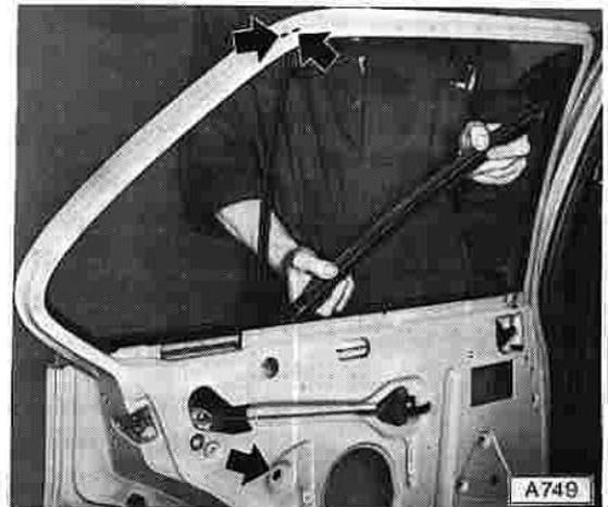
Fallfenster schräg nach oben aus dem Fensterschacht herausheben.
