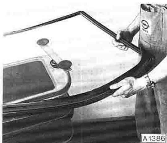
Falls erforderlich, Reste der Dichtungsmasse bzw. des Klebers mit Waschbenzin tränken und mit Holz- oder Plastikkeil entfernen.
