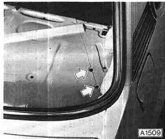
Bei Manta-B Befestigung des Automaten an der Seitenwand innen.
