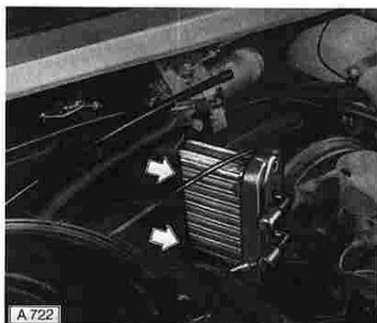
Vor dem Einbau darauf achten, daß beide Dichtungstreifen »A« seitlich am Heizkörper angebracht sind. Abgelassenes Kühlmittel wieder einfüllen.
