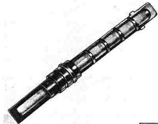
Im unteren Anschlußrohr - Verdampfereingang - ist das "Orifice-Ventil" eingesteckt, das durch seine kalibrierte, nicht veränderbare Bohrung den Kühlmittelfluß im System bestimmt.
