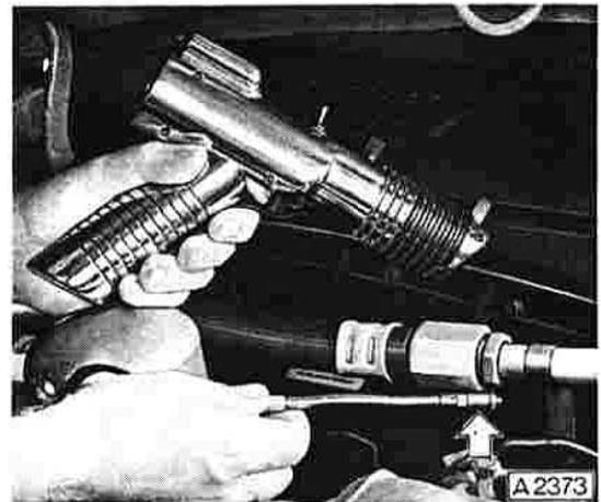
Bei der Leckprüfung müssen alle Verbindungen und Verschraubungen frei von überschüssigem Öl sein, um die Möglichkeit auszuschließen, daß durch Absorption von Kühlmittel im Öl falsche Ergebnisse entstehen.
