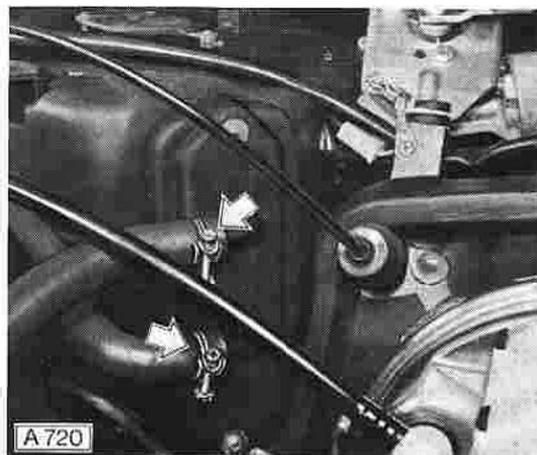
Befestigungsschrauben des Heizkörpers am Heizungsgehäuse abschrauben.
