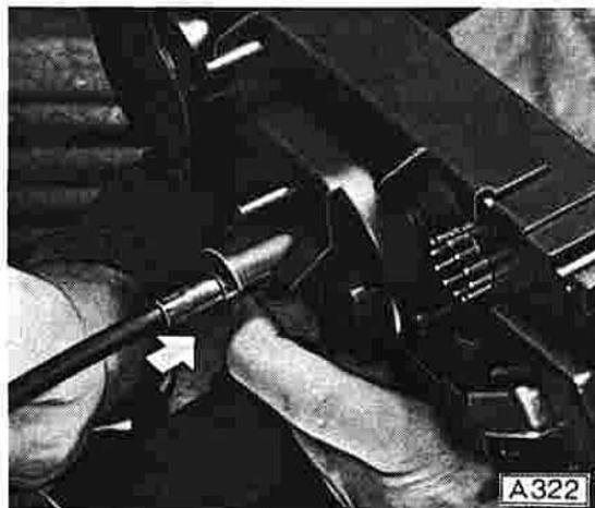
An der Tachometerrückseite Tachometerwelle vom Anschluß des Tachometers abbauen.
