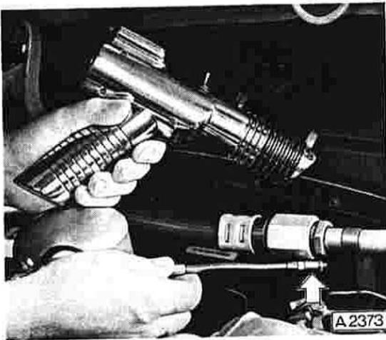
Werden etwaige Leckstellen nicht erst lokalisiert und abgedichtet, so kann beim späteren Evakuieren Luft und Feuchtigkeit in das System eingesaugt werden.
