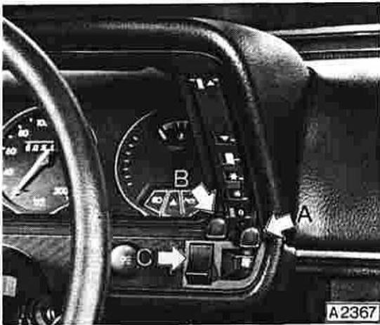
Mit dem rechten Hebel "A" für die Luftverteilung wird das Kühlsystem und das Gebläse mit der geringsten Förderleistung eingeschaltet, wobei je nach Hebelstellung die Kühlung mit Umluft oder mit Außenluft erzielt wird. Bei der Stellung "Umluft" wird die im Fahrzeuginnenraum befindliche Luft vom Gebläse über eine spezielle Klappe angesaugt, über den kalten Verdampfer geleitet und über die Düsen in der Instrumententafel wieder dem Innenraum zugeführt.
