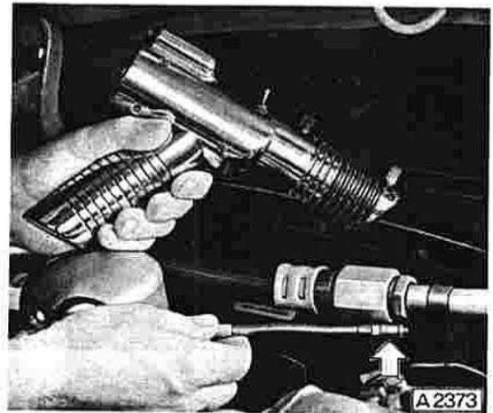
Beide Anschlußkabel von den Steckanschlüssen des Hochdrucksicherheitschalters abziehen.
