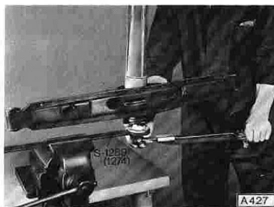
Flansch mit Kunststoffhammer von Hinterachsverlängerungswelle demontieren.
