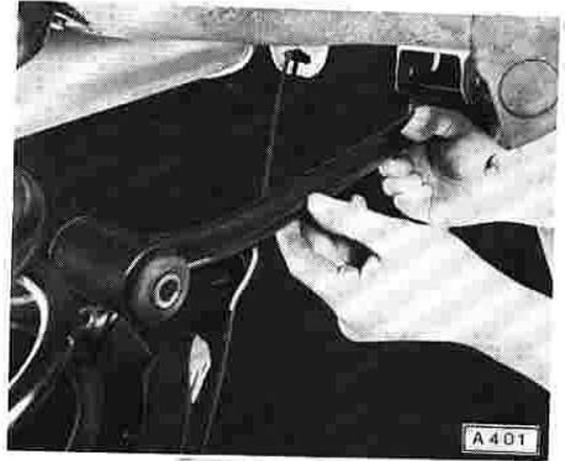
Vordere und hintere Buchse mit Dorn von S-1193 unter Presse aus Lenker herauspressen (A).
