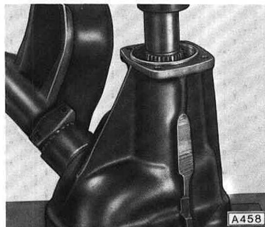
Sechskantmutter fortschreitend festziehen, dabei laufend Lagervorspannung mit Torsionmeter 76/25 prüfen.
