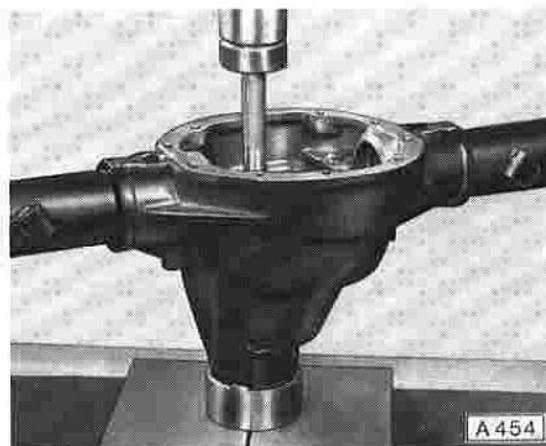
Kegelkäfig von Antriebskegelrad abpressen.
