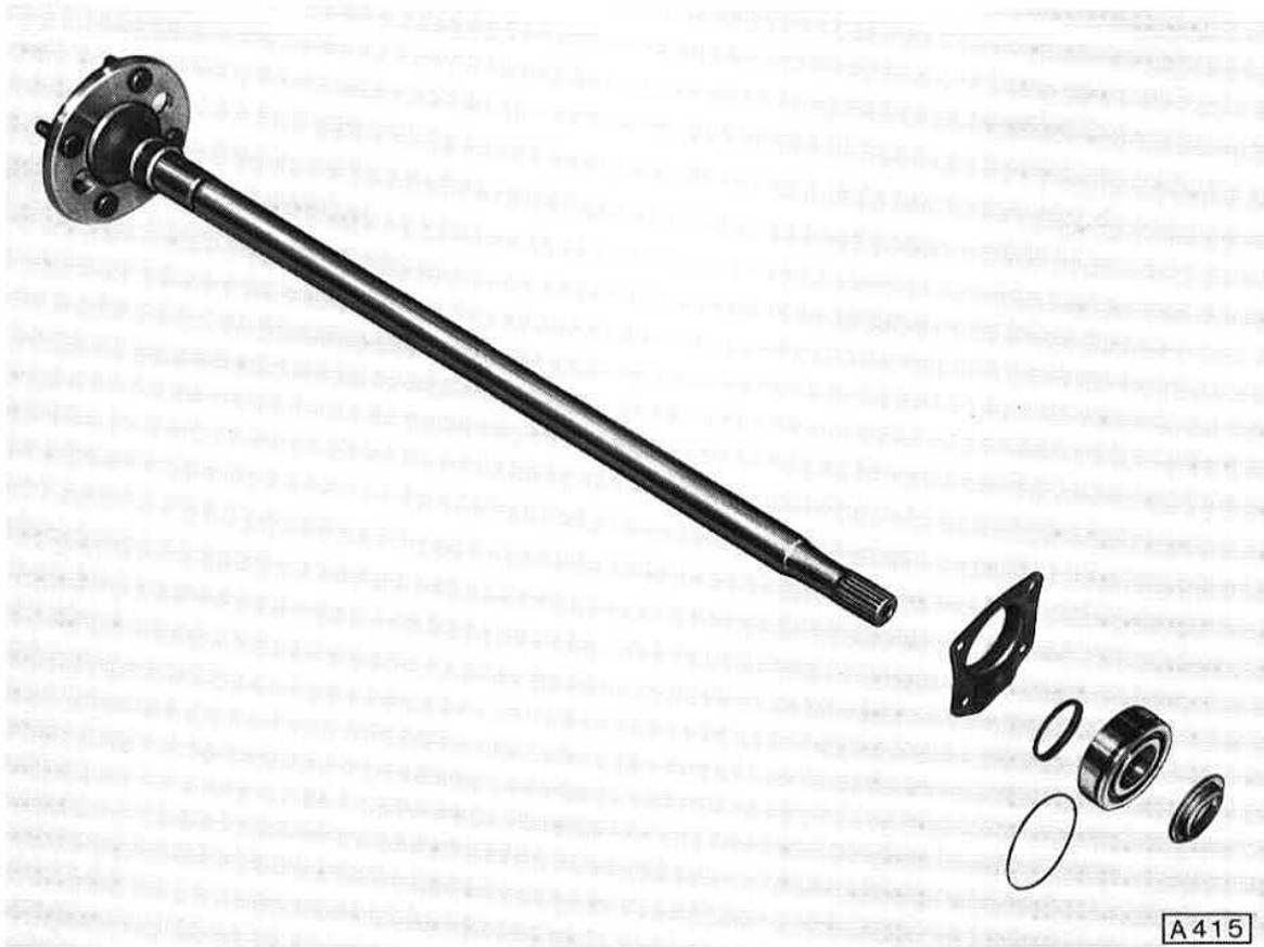
Lagerteile einer Hinterachswelle bei Fahrzeugen mit 12 S- und 16 N-Motoren.
