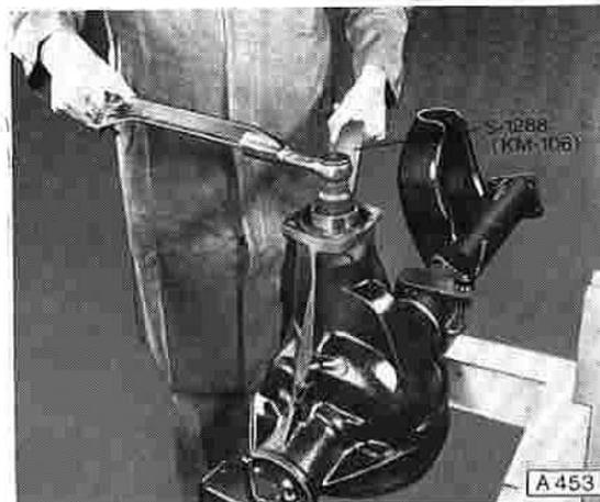
Äußeren und inneren Laufring aus Hinterachsgehäuse
