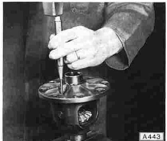
Nach Demontage von Tellerrad und Ausgleichachse
