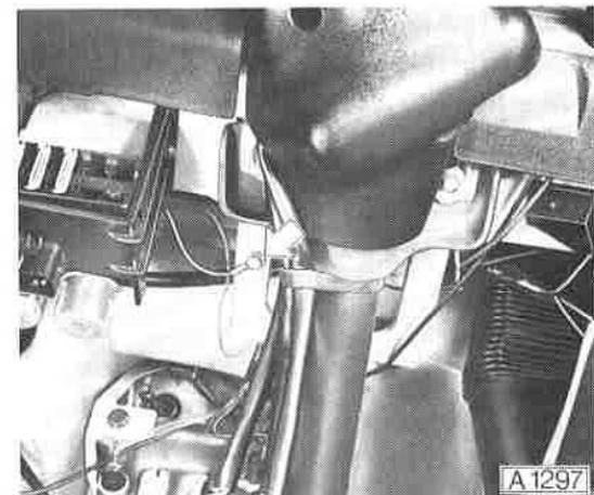
Anschluß der Schalterklemme "58" am Sicherungskastenanschluß "B".
