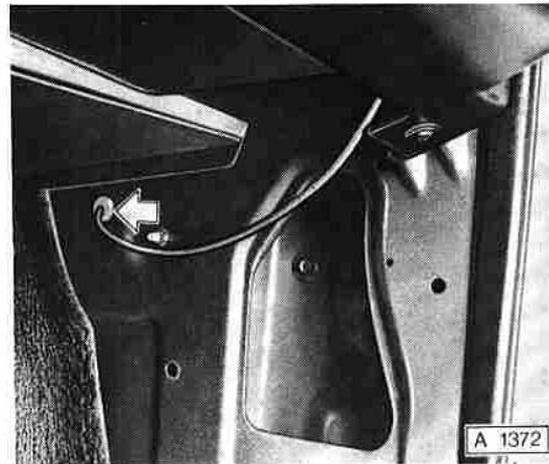
Parkleuchenschalterzuleitungen am Steckhülsengehäuse des Lenkschloßkabelsatzes anschließen. In Sicherungshülse Sicherung einsetzen. Sicherungshülse mit Federschelle am Halter für Lenkungsbefestigung befestigen.
