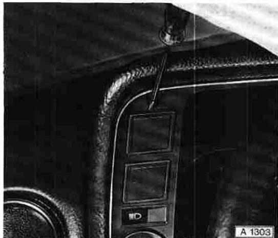
In Stirnwand Loch  $\varnothing$  12 mm für Nebelscheinwerferkabelsatz bohren.
