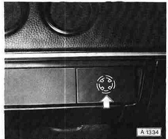
Deckel über Sicherungskasten abnehmen.
