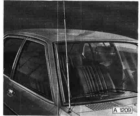
Antennenloch  $\varnothing$  18,5 mm entsprechend den angeführten Maßen bohren. Auf der Kotflügelunterseite Anlagefläche der Antenne gut blankschaben.
