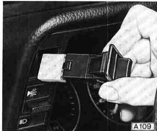
Zum Ersatz der Symbolbeleuchtungs-Lampe ist die Leuchtenfassung mit Lampe nach hinten aus dem Schalter herauszuziehen.
