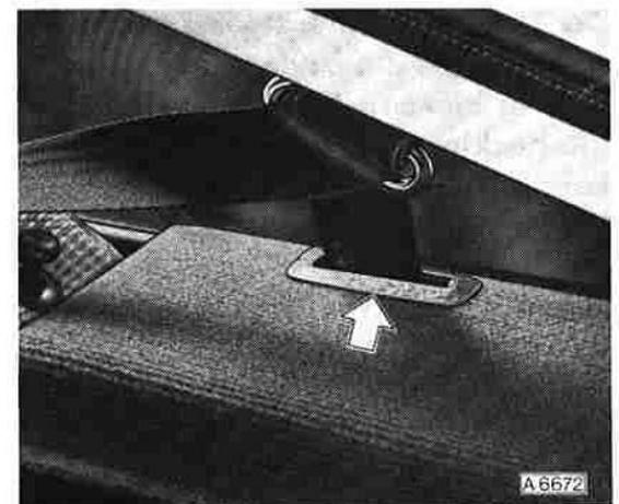
Gurthalterungen am Radeinbau und Bodenblech anschrauben.
