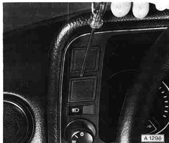
Nebelschlußleuchten-Zuleitung durch Rückwand in Nebelschlußleuchte führen und anschließen.
