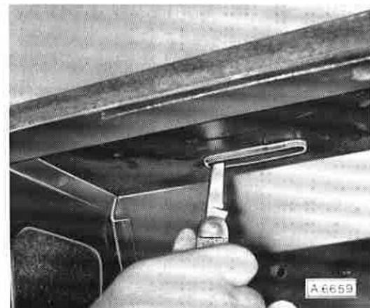
In linke und rechte Seitenwand Verstärkungsplatte einsetzen. Platten mit je 2 Blindnieten befestigen.
