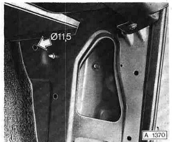
Lampenträger mit Unterlage an beide Kotflügel anschrauben.
