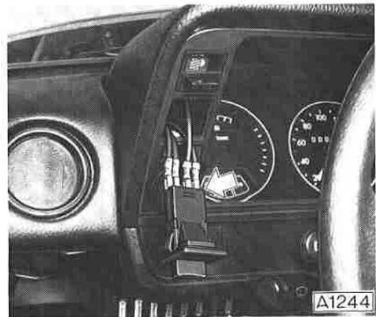
Massekabel des Schalters an der Zentralmasseschraube mit anschrauben.
