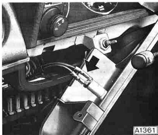
Sicherungskasten von Instrumententafel
