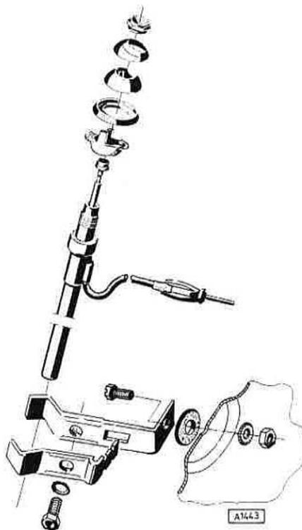
Antennenkabel mit Tülle durch Seitenwand führen.
