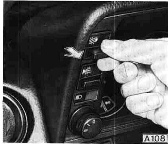
Mehrfachstecker vom Nebelscheinwerferschalter abziehen.
