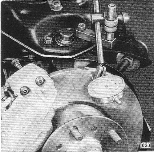
Zum Prüfen des Seitenschlages der Bremsscheibe ist die Meßuhr und der Halter von S-9 nach der Anordnung in nebenstehendem Bild am oberen Lenker zu befestigen. Zum Festschrauben des Halters ist eine entsprechend lange Schraube zu verwenden, wobei zuvor eine Schraube für Tragelenk an oberem Lenker abzuschrauben ist.
