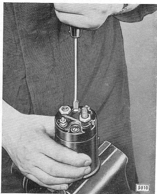
Bild D 72 - Magnetschalterdeckel abschrauben
