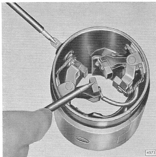
Bild D 74 - Feldwicklung auf Unterbrechung prüfen
