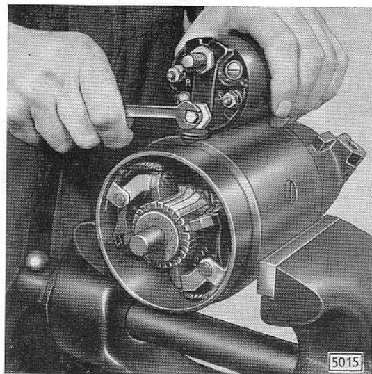
Bild D 67 - Schrauben von Magnetschalter-Klemmschraube abschrauben
