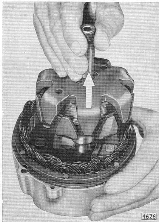
Bild D 38 - Läufer aus Ständer herausziehen
