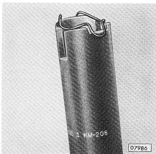
Sicherungsklammer in Kofferraum-Schließzylinder-Montagewerkzeug KM 206 so einlegen, daß die gebogene Öse der Klammer in der Aussparung des Montagewerkzeuges liegt. Die Sicherungsklammer wird durch Magnete im Montagewerkzeug gehalten.
