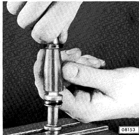
Zum Einschrauben der Anschlagsschraube sowie zum Einsetzen der Sekundärmanschetten Montageadel wie beim Zerlegen in Nachlaufbohrung des hinteren Kreises einstecken.
