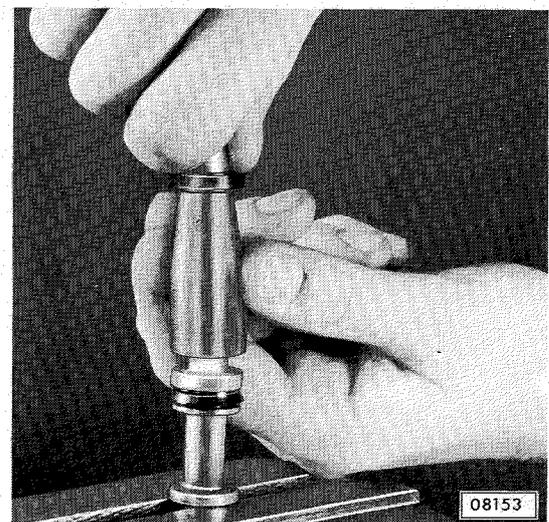
Die Kolben in Zylindergehäuse einbauen.
