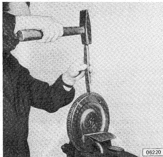
Neuen Anlaßzahnkranz gleichmäßig auf 180 bis 230° C erwärmen (strohgelbe Anlauffarbe) und - Innenfase zum Schwungrad - mit Messingdorn gleichmäßig bis zur satten Anlage auftreiben.
