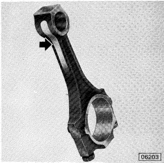
Mit dem Meßstift wird auf das Kolbenbolzenauge sowie den oberen Teil des Pleuelstangenschaftes Farbstoff aufgetragen und die Pleuelstange mit dem oberen Auge auf die Heizplatte gelegt. Um einen schnellen und gleichmäßigen Wärmefluß zu erhalten, ist darauf zu achten, daß die Augenfläche vollkommen plan auf der Heizplatte aufliegt. Eine entsprechend der Höhe der Heizplatte angepaßte Unterlage ist dazu erforderlich. Um Wärmeab-
