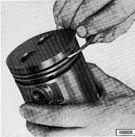
Angesetzte Ölkohle mit durchgebrochenem und keilförmig geschliffenem Kolbenring vom Nutgrund entfernen.
