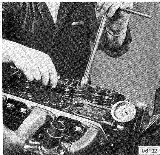
Dazu 1. Zylinder auf Zünd-OT stellen. Erhabene Strichmarkierung auf dem Steuergehäusedeckel und die Einstellwarze auf der Kurbelwellenriemenscheibe stehen gegenüber, die Ventile des 4. Zylinders wechseln.
