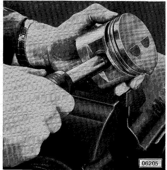
Das Einschieben des Kolbenbolzens in den Kolben und die Pleuelstange muß schnell und zügig geschehen, um vor dem rasch erfolgenden Abkühlen der Pleuelstange und dem damit verbundenen Festsitz des Kolbenbolzens den Montagevorgang bereits beendet zu haben. Ein festsitzender Kolbenbolzen kann ohne Risiko einer Kolbenverformung nicht mehr nachgedrückt werden.
