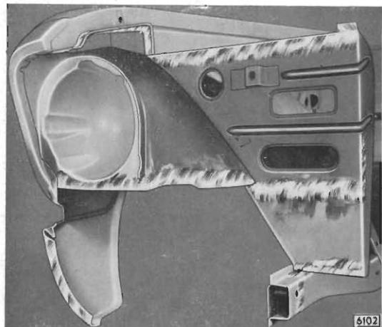
Bild B 17 - Anlageflächen für oberes Luftleitblech,
