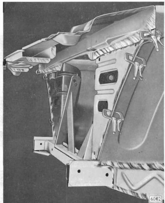
Bild B 13 - Oberes Luftleitblech in Einbaulage gebracht
