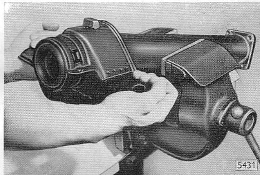
Bild B 27 - Brücke von Hinterachsverlängerung abziehen
