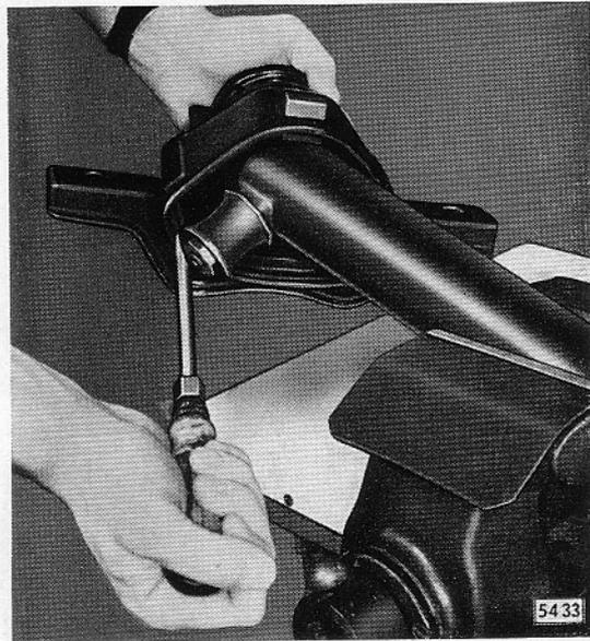
Bild B 29 - Gummipuffer an Hinterachsverlängerung in Brücke hineinzwingen
