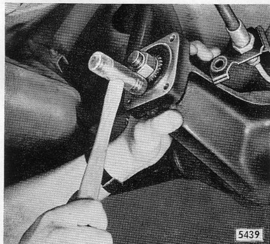
Bild B 41 - Antriebskegelraddichtring in Hinterachsgehäuse einschlagen
