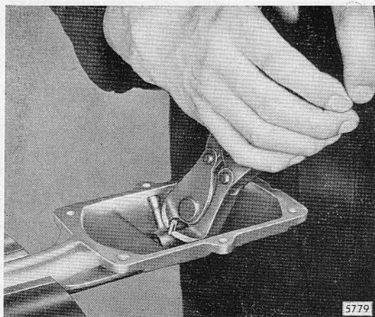
Bild B 19 - Spiralstift aus Schaltfinger herausziehen
