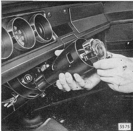
Bild B 18 - Signalschaltergehäuse und Lenkstützrohrverkleidung vom Lenkstützrohr abziehen
