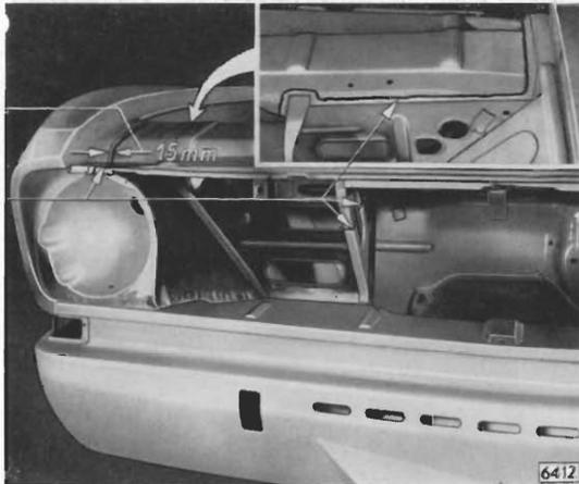
Bild B 10 - Trennlinie auf rechter Wagenseite – auf linker Wagenseite in gleicher Weise vorgehen. Bildausschnitt zeigt rechte Wagenseite, vom Motorraum aus gesehen
