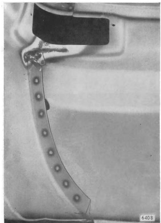
Bild B 9 - Vorderkotflügel an unteres Luftleitblech punktgeschweißt - von Wageninnenseite aus gesehen
