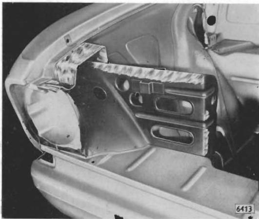
Bild B 11 - Anlageflächen für oberes Luftleitblech blankgesäubert
