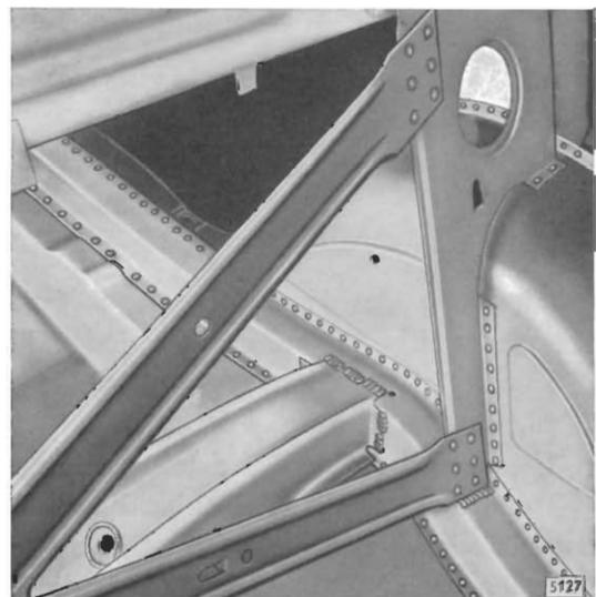
Bild 77 - Diagonalverstrebung angepunktet
