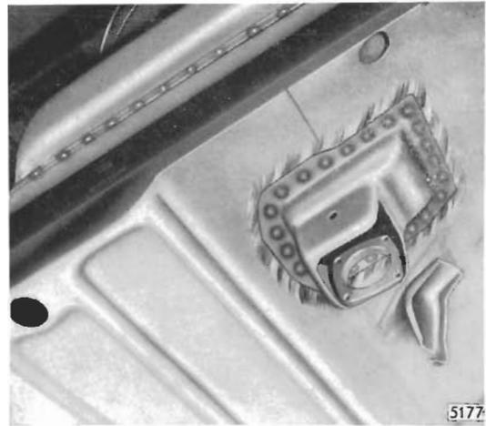
Bild 96 - Hinterfederstütze an Bodenblech lichtbogenpunktgeschweißt oder mit kurzen Raupen lichtbogengeschweißt
