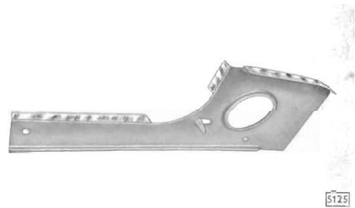
Bild 75 - Seitenteil-Diagonalverstrebung blank-gesäubert
