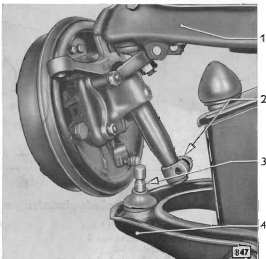
Bild 29 - Kugelbolzenschaft aus Achsschenkelrohr ausgeführt
