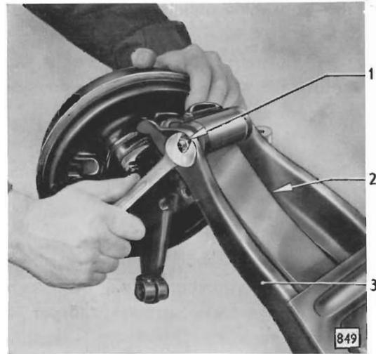
Bild 48 - Unteren Lenker an Vorderfeder befestigen
