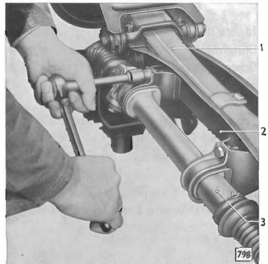
Bild 23 - Lenkgetriebe mit Spurstangen abschrauben
