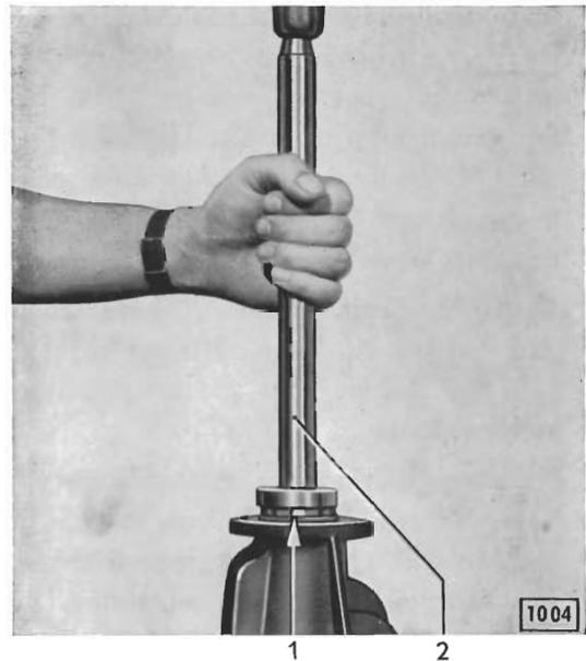
Bild 81 - Dichtring für Antriebkegelrad in Hinterachsgehäuse einschlagen
