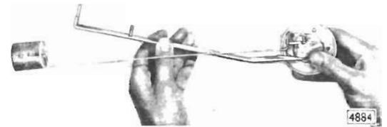
Bild 5 - Verbogener Schwimmhebel mit Prüfllehre
