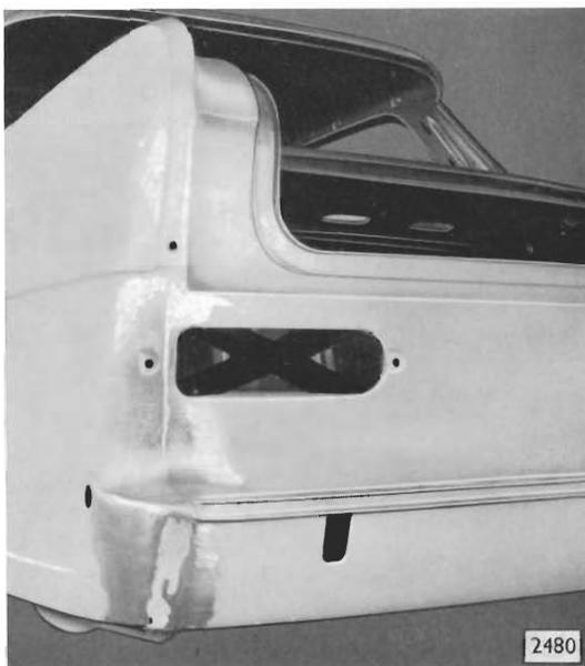
Bild 159 - Auf linker Wagenseite mit Lötzinn ausgeschwemmte Verbindungsstellen nachgearbeitet – auf rechter Wagenseite in gleicher Weise vorgehen
