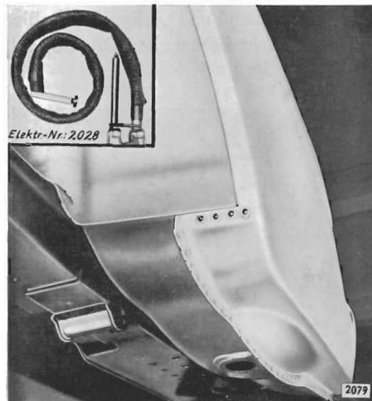
Bild 126 - Seitenwand an hinteren unteren Flansch des Radeinbaues stoßpunktgeschweißt
