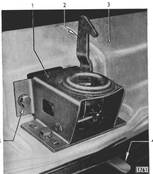
Bild 49 - Haubenverschluß am oberen Luftleitblech
