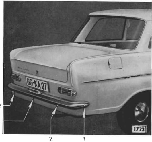
Bild 64 - Hintere Stoßstange eingebaut
