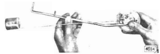
Bild 5 - Verbogener Schwimmerhebel mit Prüflehre
