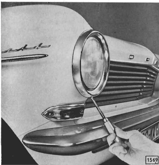
Bild 2 - Zierring vom Scheinwerfer abschrauben
