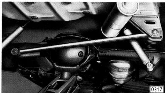
Hinterachse so weit wie möglich anheben. Dann Schubstange von Achse und Rahmenlängsträger abschrauben.
