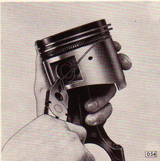
Beim Ausbau der PC-Ringe zuerst Stahlbandringe einzeln mit Kombizange, an einem Stoßende gefaßt, aus Ringnut spiralförmig herausziehen und über den Kolbenschaft nach unten abstreifen, dann Zwischenring abnehmen.
