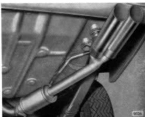
Der hintere Auspufftopf mit beiden Endrohren wird nur im Zusammenbau geliefert.
