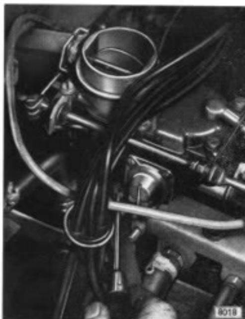
Beide Leerlauf-Einstellschrauben soweit zurückdrehen, daß die Drosselklappen geschlossen sind. Darauf achten, daß beide Drosselklappen einwandfrei zugezogen werden.
