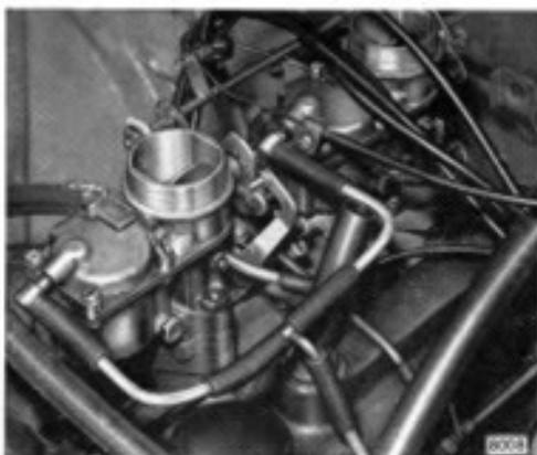
◁ Starterzug, Kraftstoffschläuche, Unterdruckschlauch für Unterdruckdose und Motorentlüftungsschlauch abnehmen.
