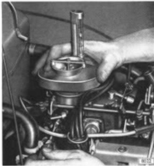
◀ Synchro-Testgerät auf den Luftstutzen des hinteren Vergasers aufsetzen und mit der Leerlauf-Einstellschraube Drosselklappe so einstellen, daß das Gerät den gleichen Wert anzeigt, wie beim vorderen Vergaser.
