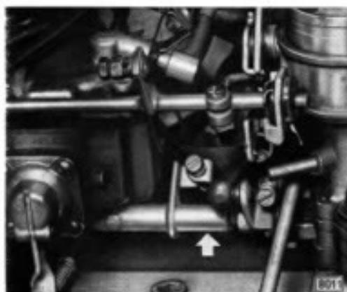
Betätigungsgestänge für Starterklappen abschrauben und Rückzugfeder aushängen.
