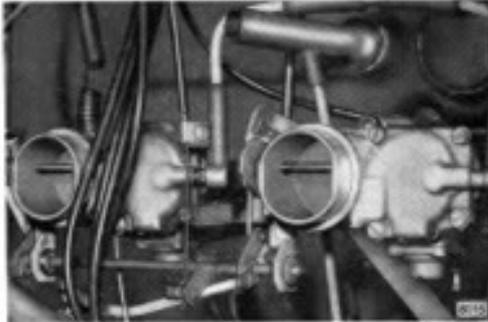
Um ein einwandfreies Arbeiten der Zweivergasieranlage zu gewährleisten, muß die LeerlaufEinstellung äußerst gewissenhaft durchgeführt werden.
