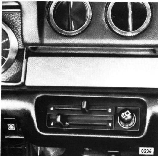
Lochabdeckung durchstoßen. Zigarrenanzunder in die Heizungsbetätigung mit Masseblech einbauen.
