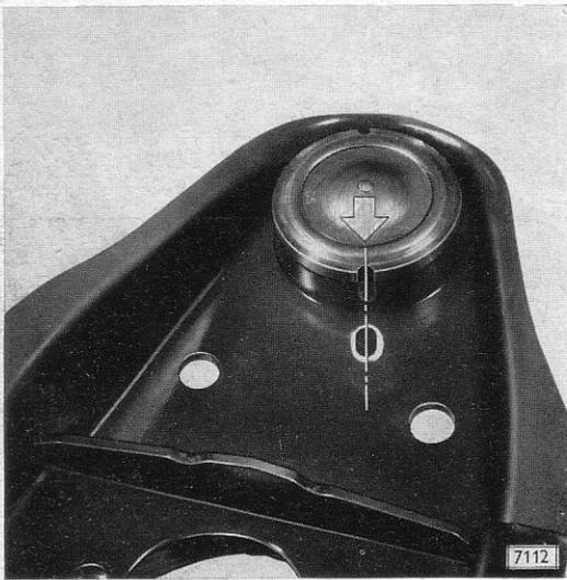
◀ Vor dem Einziehen eine Nut im Traggelenkgehäuse zur Markierungswarze im unteren Lenker ausrichten. Zulässige Abweichung  $\pm 2^\circ$ .
