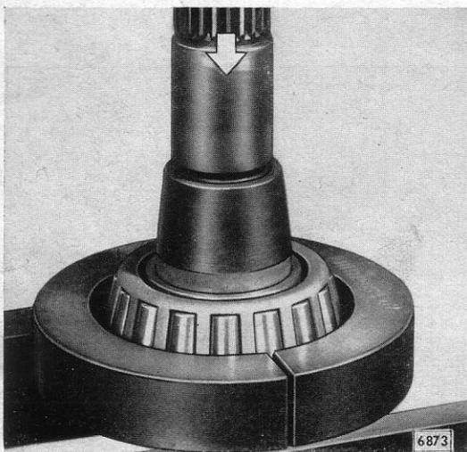
◀ Kegelkäfig von Antriebskegelrad mit S-1307 abpressen.
