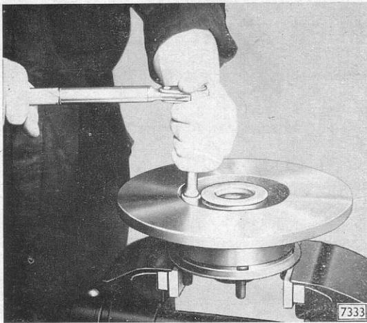
Radnabenkappe mit S-1257 abziehen. Vorderradnabe mit Bremsscheibe aus- und einbauen.
