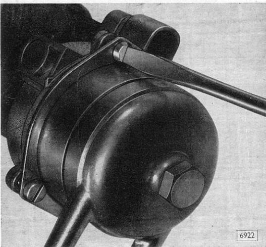
◀ Haltering von Starterkörper abschrauben und Starterdeckel abnehmen.
