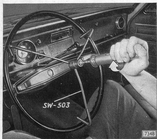
Beim Aufstecken des Lenkstockhebels müssen die breiten Zähne des Hebels mit den breiten Nuten der Lenkstockwelle genau übereinstimmen.
