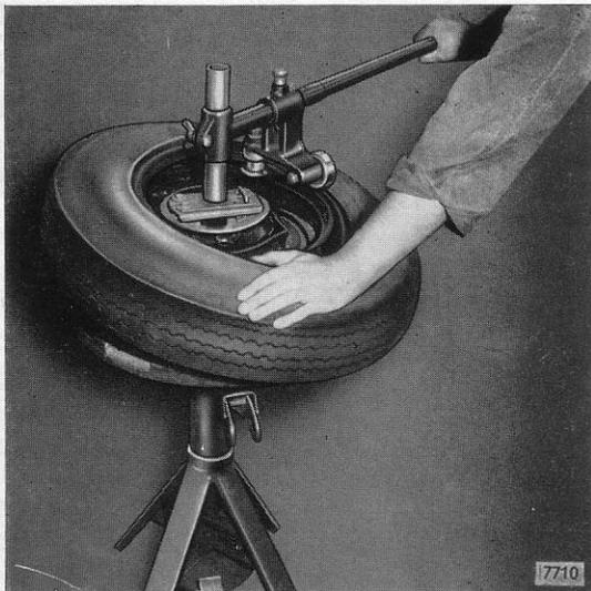
◀ Reifen mit Reifenmontiergerät auf Felge aufziehen.
