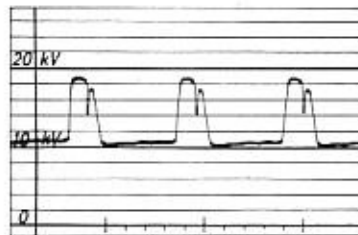
Unterbrechung einer Plusdiode
