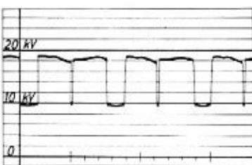
Phasenfehler und kurzgeschlossene Minusdiode
