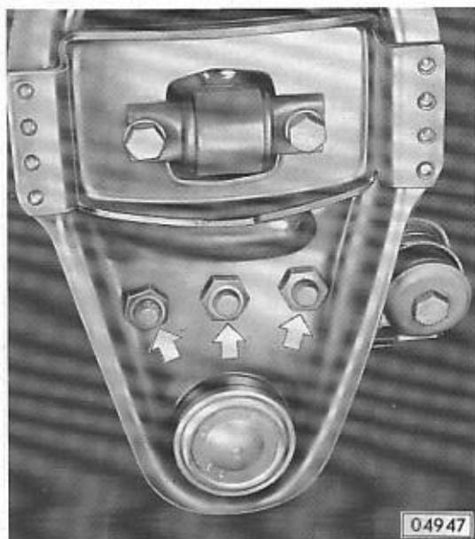
Stabilisatorhalter am unteren Lenker festschrauben – **7,5 kpm**. Neue selbstsichernde Muttern verwenden.
