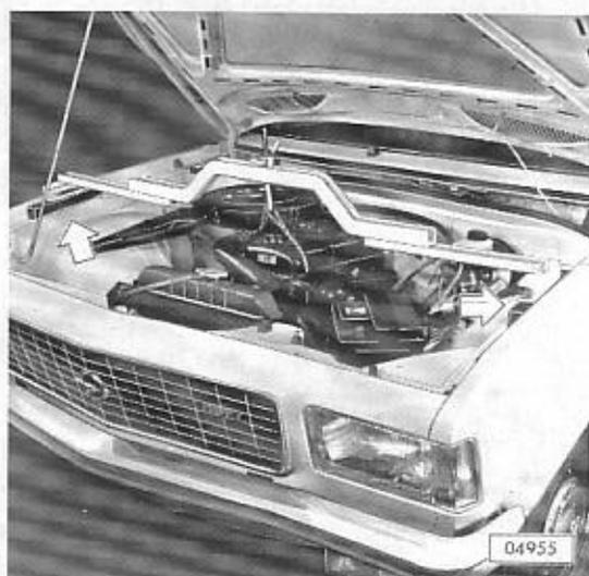
Motor am Motorheber S-1244 und Drahtseil S-1220 mit einer Länge von 1500 mm aufhängen. Um eine Verformung der Kotflügel zu vermeiden, sind unter die Aufnahmen des Motorhebers am Kotflügel rechts und links Vierkantrohre 30 x 30 x 250 mm unterzulegen.
