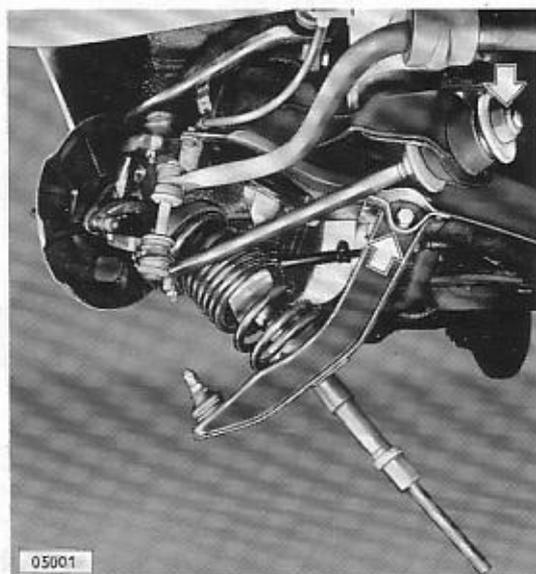
Entspricht Vorgang „Vorderfeder ersetzen“, zusätzlich unteren Lenker am Achskörper ab- und anschrauben.
