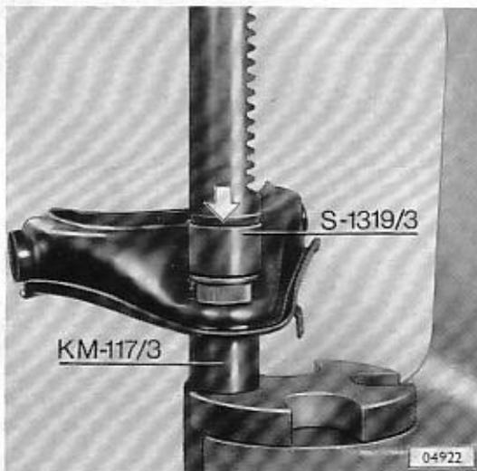
Führungsgelenk mit Montagewerkzeug S-1319/3 und KM-117/3, wie im Bild gezeigt, einpressen.
