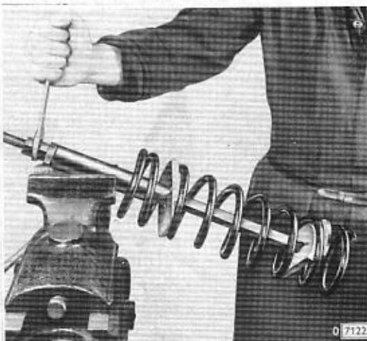
Beim Spannen der Vorderfeder sind möglichst 7 Federwindungen zwischen die Spannplatten einzufassen.
