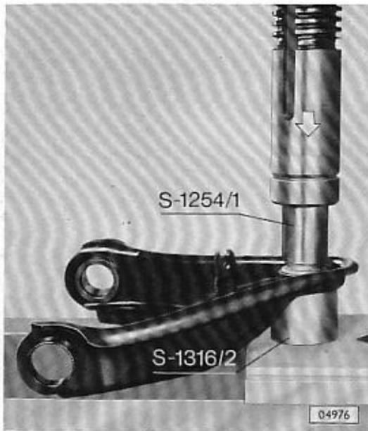
Führungsgelenk mit Montagewerkzeug S-1254/1 und S-1316/2, wie im Bild gezeigt, auspressen.
