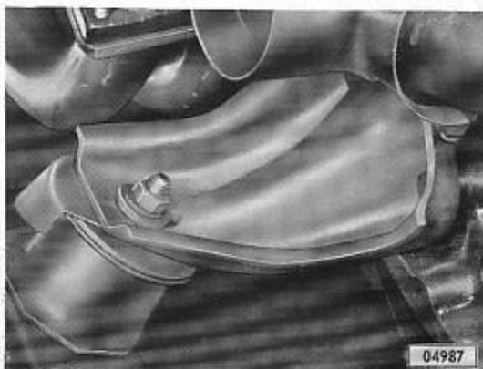
Äußere Spurstange an den Lenkhebeln abschrauben, Kugelbolzen-Ausdrückvorrichtung S-1235 verwenden.
