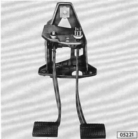
Bock für Bremskraftverstärker an Stirnwand und Stütze für Tandem-Hauptbremszylinder am Radeinbau abschrauben.
