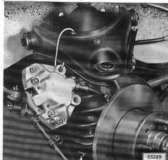
Beim Einbau sind die Lagerteile der Radnabe mit Wälzlagerfett, Katalog-Nr. 19 46 254, einzufetten.
