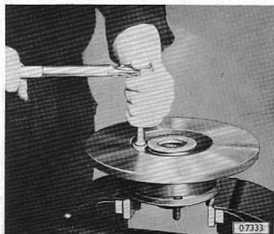
Um ein gleichmäßiges Bremsen beidseitig zu gewährleisten, müssen beide Bremsscheiben die gleiche Oberfläche bezüglich Schliffbild und Rauhtiefe aufweisen. Deshalb müssen grundsätzlich beide Bremsscheiben ersetzt werden.
