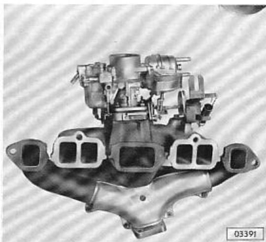
Luftfilter abschrauben. Vergaser-Seilzug aushängen und alle Leitungen, die zum Vergaser führen, von den Anschlußstutzen abziehen. Haltewinkel für Auspuffkrümmer mit 15-mm-Ringschlüssel vom Motorblock und mit 13-mm-Gelenkschlüssel vom Auspuffkrümmer lösen.
