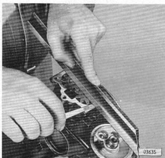
Höhenspiel der Zahnräder prüfen. Dazu Ölpumpenräder **ohne** Öl einzeln in Pumpenraum einsetzen und mit Haarlineal und Fühllehre Höhenspiel messen. Zulässiges Höhenspiel ist vorhanden, wenn die Stirnflächen der Zahnräder **0 bis 0,10 mm** über der Deckelanlagefläche hervorstehen. Ein durch die Zahnräder stirnseitig eingelaufener Pumpendeckel ist zu erneuern.
