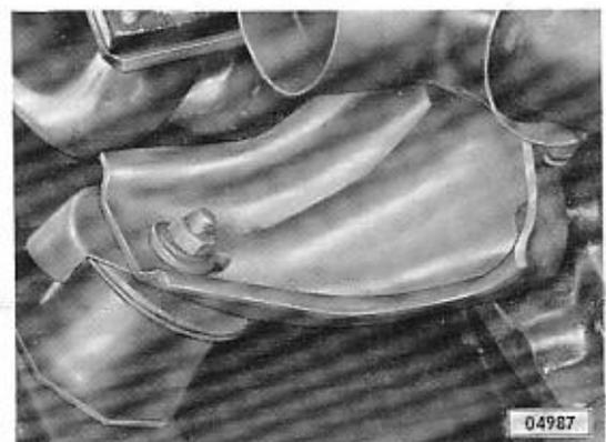
Gelenkwelle ausbauen (siehe Arbeitsvorgang in Gruppe 4). Dabei gegen Ausfließen von Öl Abdichthülse SW-191 auf Getriebehauptwelle aufstecken. Bei Wagen mit automatischem Getriebe Abdichthülse S-1279 verwenden.
