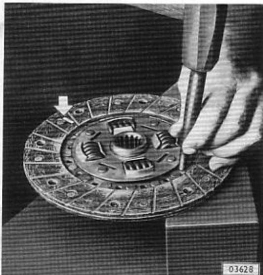
Unwucht durch Bleiniet – entgegengesetzt des Schwerpunktes angebracht – beseitigen.
