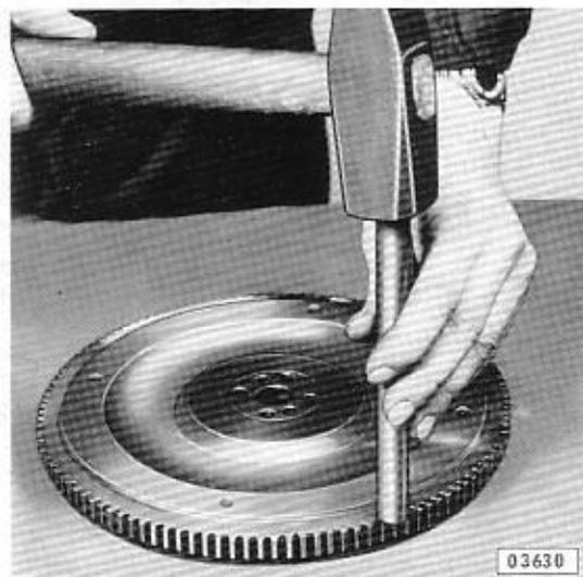
Neuen Anlaßerkranz gleichmäßig auf 180–230° C erwärmen (strohgelbe Anlauffarbe) und – Innenfase zum Schwungrad – mit Messingdorn gleichmäßig bis zur satten Anlage aufreiben.
