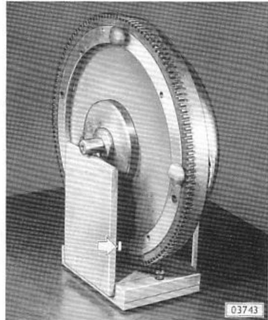
Schwungrad mit Kupplungszusammenbau um 90° drehen, so daß die zuletzt angebrachte plastische Masse waagrecht zur Drehachse zu liegen kommt und durch Zugeben oder Abnehmen von plastischer Masse Unwucht beseitigen. Auswuchtsatz muß in jeder Drehlage stillstehen.
