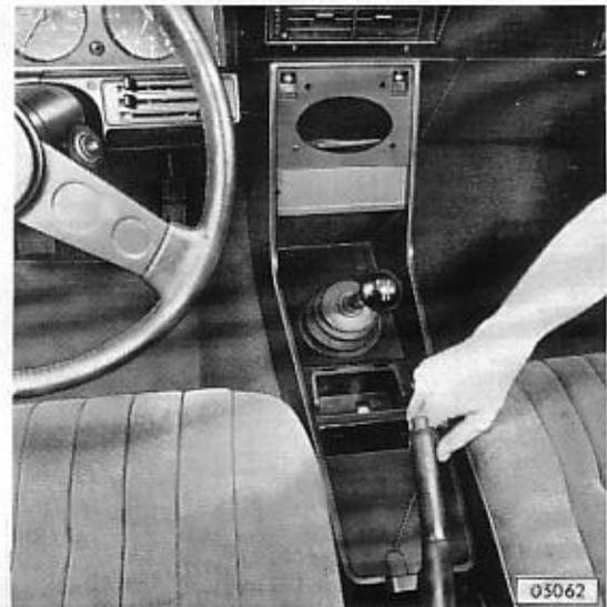
Gelenkwelle kompl. mit Zwischenlager ausbauen (siehe Arbeitsvorgang in Gruppe 4). Abdichthülse S-1279 auf Getriebehauptwelle aufstecken.
