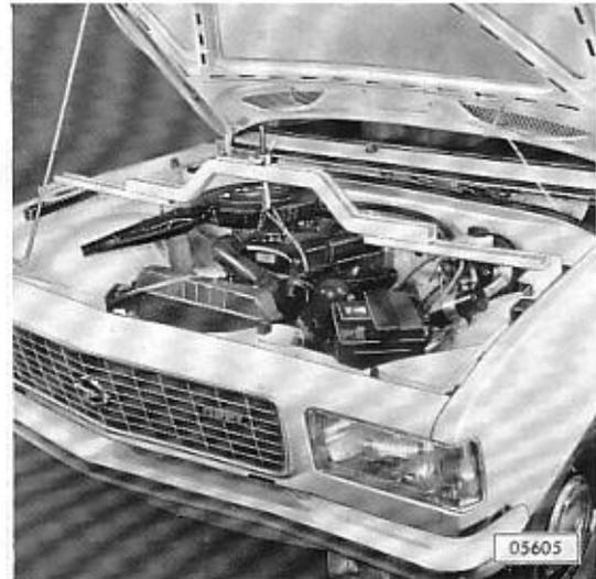
Dämpfungsblock mit Motordämpfungsblock-Montageschlüssel KM 127 vom Achskörper abschrauben und auswechseln. Motor ablassen. Seil entfernen und Motorbefestigung rechts und links auf **4 kpm** festziehen.
