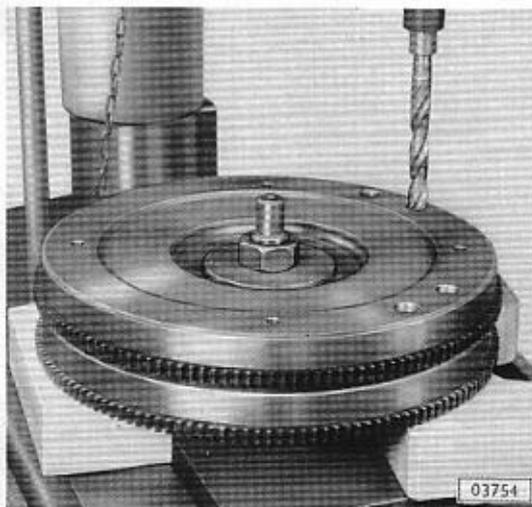
Auswuchtsatz aus Auswuchtbock herausnehmen und so viel Material am neuen Schwungrad an der mit Kreide gekennzeichneten schwersten Stelle ausbohren, wie dem Gewicht der plastischen Masse entspricht.
