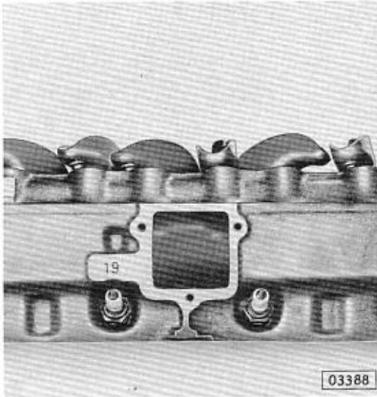
Bei Verwendung eines neuen Zylinderkopfes muß auf die eingeschlagene Unterscheidungskennzeichnung seitlich neben dem Verschlußdeckel bzw. auf die angegossenen senkrechten Rippen an der vorderen Stirnseite des Zylinderkopfes geachtet werden.
