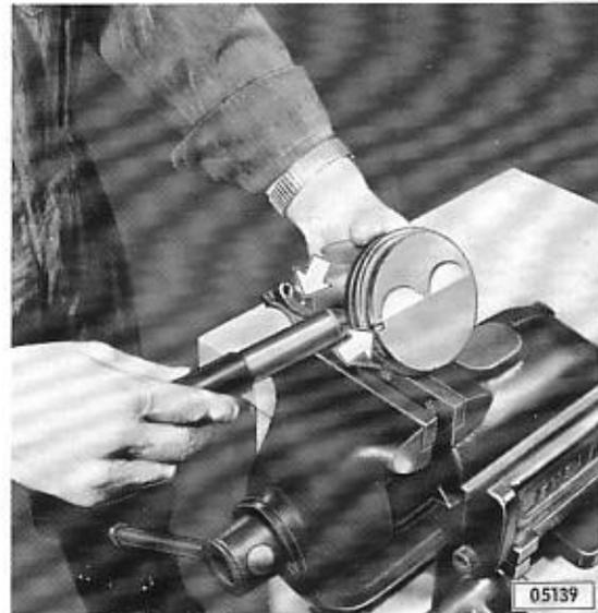
Ersatzteilmäßig werden nur Pleuelstangen der höchsten Gewichtsklasse geliefert. Eine vereinfachte Gewichts-anpassung einer einzelnen Pleuelstange zu den noch im Motor befindlichen Stangen durch Abschleifen an beiden Gewichtszapfen ist dadurch gegeben.
