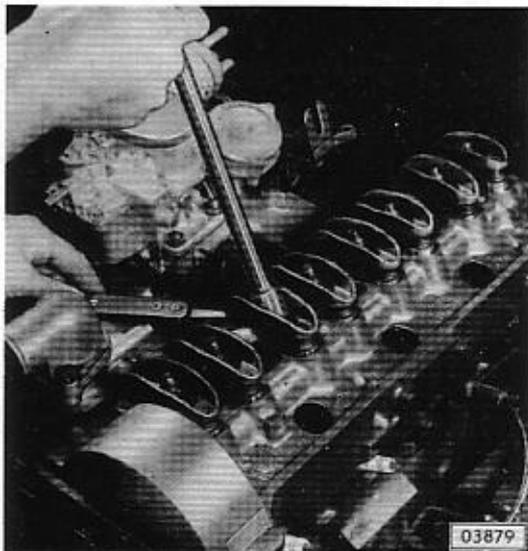
Ventilspiel bei Betriebstemperatur (ca. 80° C Kühlmittel und 60° C Öl) bei laufendem Motor mit 0,30 mm-Fühllehre, die sich saugend zwischen Kipphebel und Stößel bewegen lassen muß, prüfen.
