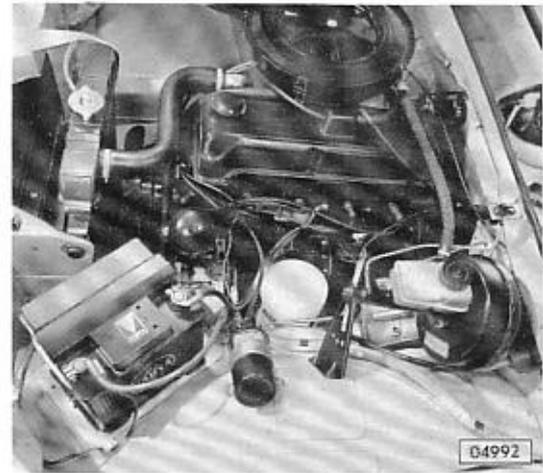
Mutter links wie rechts vom Gewindebolzen für vordere Motoraufhängung an Dämpfungsblock abschrauben.
