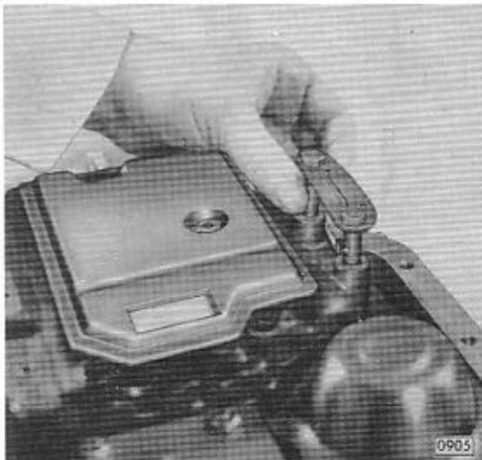
Rastfeder und Rolle, die durch 2 Befestigungs-schrauben der Schaltautomatik gehalten wer-den, ausbauen.
