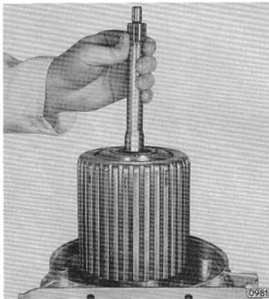
Den 2. und 3. Gang-Kupplungszusammenbau an der Antriebswelle hochheben und in das Getriebegehäuse einsetzen, wobei die Verzahnung des Außenrades in der 2. Gang-Kupplung mit der der langen Planetenräder in Eingriff zu bringen ist.
