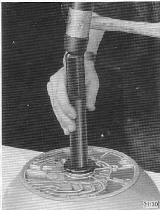
Wandlergehäuse gründlich säubern und neue Buchse von **Ölpumpenseite** mit Werkzeug KM-109 und Dorn KM-J-8092 bis zum Anschlag in Wandlergehäuse eintreiben. Die Einpreßtiefe der Buchse ist durch das Druckstück gegeben.
