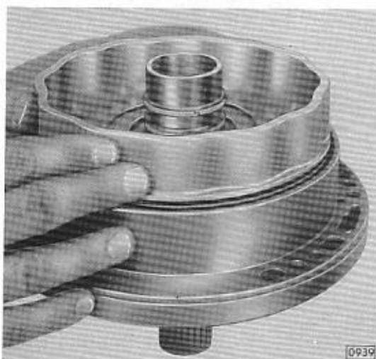
Die Entlastungsfedern der Rückwärtskupplung auf Bruch oder Verzug prüfen. Falls notwendig, Federn ersetzen. Die 24 Entlastungsfedern und den Federsitz einlegen.
