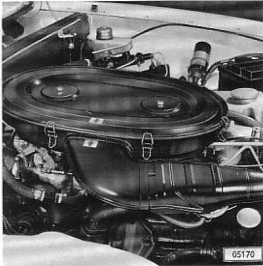
Bild zeigt Luftfilter 25 H-Motor
