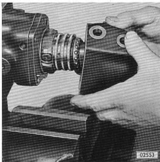
Ventilgehäuse von oben aufsetzen und Schrauben auf **3,5 kpm** festziehen.
