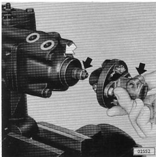
Kronenmutter der Klemmschraube für Lenktriebflansch auf **2,5 kpm** festziehen und versplinteln. Die Gummi-Schutzkappe darf beim Drehen der Spindel nicht am Ventilgehäuse schleifen. Beide Flansche des Scheibengelenkes müssen mit einem Masseverbindungskabel überbrückt sein.
