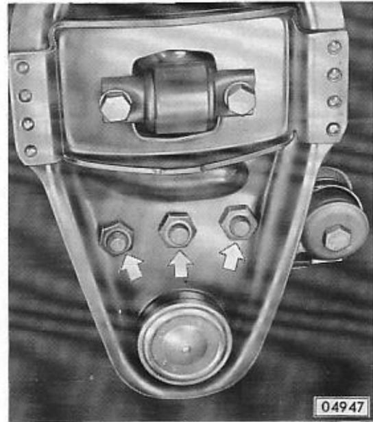
Unter Berücksichtigung des Einstellmaßes von 348 mm bei Rekord und 346 mm bei Commodore zwischen Kopfmitte vorderem Nietkopfbolzen und Hinterseite innerer Mutter darf die Zugstrebe nur **max. + 2 mm bis - 5 mm** verstellt werden, da sonst die Vorderfeder seitlich im Achskörper angeht.
