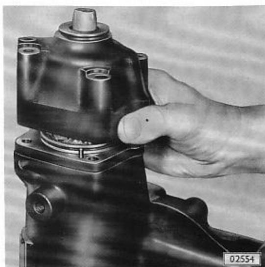
Scheibengelenk so auf die Verzahnung aufstecken, daß das **Klemmschraubenloch** des Lenkspindelbrennsches – bei genauer Lenktriebmittelstellung und nach unten zeigendem Lenkgehäusehals – nach **oben** zeigt. Bei Lenktriebmittelstellung muß der Markierungsriß auf der Spindel-Stirnseite mit dem auf dem Ventilgehäuse übereinstimmen.
