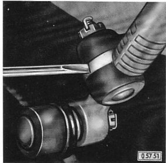
Zapfengelenk mit Kugelbolzen-Abzieher S-1136 aus Lenkzwischenhebel herausdrücken.
