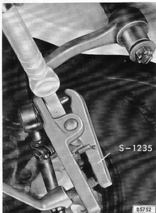
Kugelgelenk mit Kugelbolzen-Ausdrückvorrichtung S-1235 aus Lenkhebel oder mittlerer Spurstange herausdrücken.
