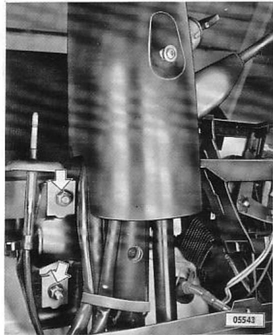
Lenkstützrohr-Zusammenbau mit Stirnwandeckel vorsichtig ablegen. Jede Art von Stoß- oder Schlagwirkung auf den Zusammenbau vermeiden.
