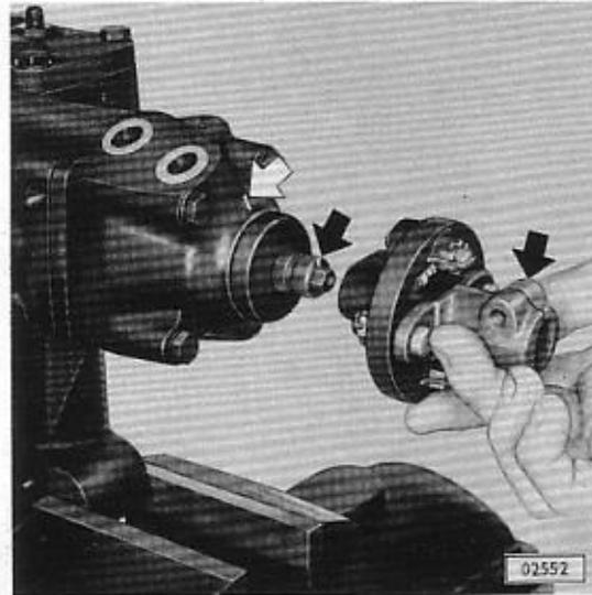
Die Gummischutzkappe darf beim Drehen der Spindel nicht am Ventilgehäuse schleifen.
